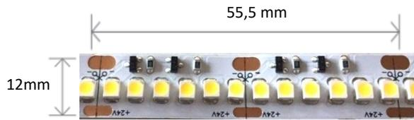
Diese Lichtbänder werden mit **24 V** betrieben und sind mit dem LED-Chip SMD 5630 von Samsung ausgerüstet. Jedes Segment verfügt über einen IC zur Stromregelung, um eine konstante Helligkeit über das gesamte Lichtband zu gewährleisten.
